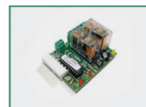
D111704 - SSR5 Плата управления для светофора и обогрета для панели управления RIGEL 5. Устройство способно функционировать при -20° с этой деталью.
