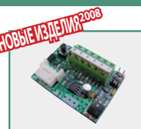
P111408 - SCS WIE Плата для прямого соединения аксессуаров WIEGAND (типа SELETTO, COMPAS SLIM, и т.д.) к модулям управления QSC D MA, LIBRA C MA, LIBRA C MV, LIBRA C LX, VENERE D, LEO D MA, LEO MV, RIGEL 5 и ALTAIR P.
